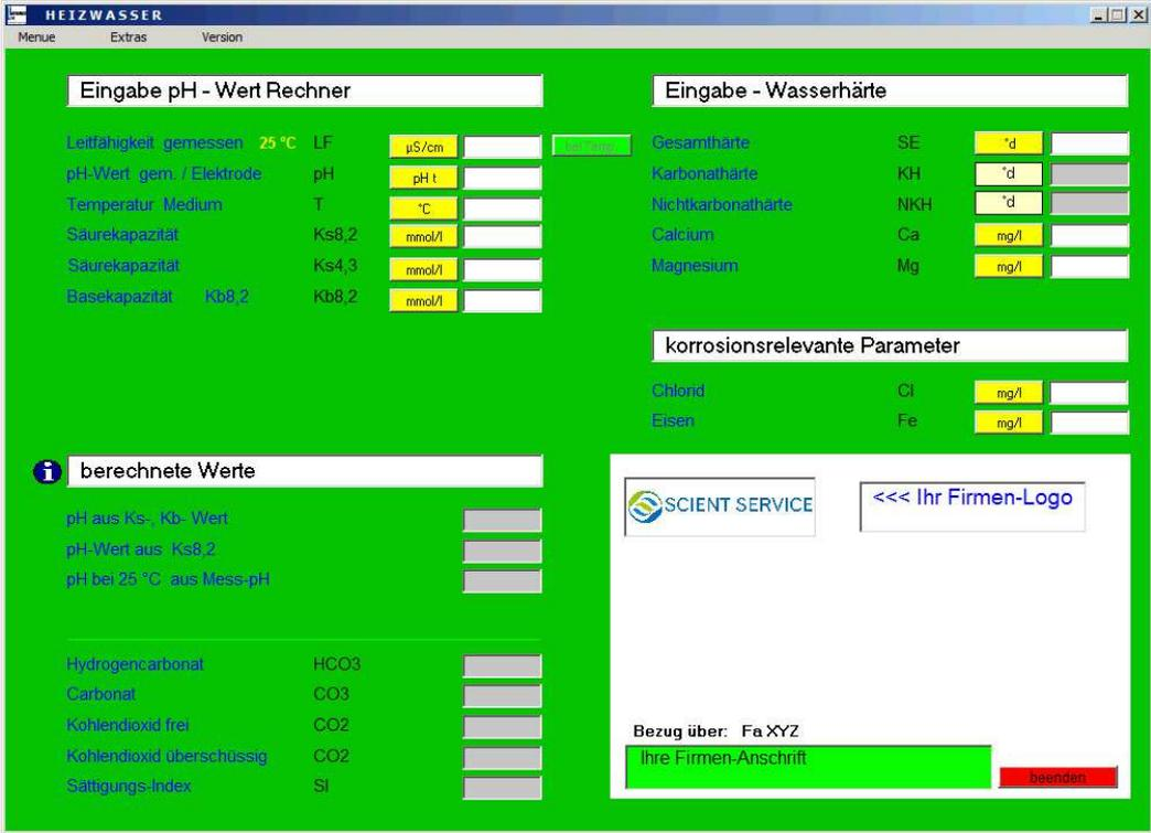
Mit der Software können Heizungswässer oder andere wenig gepufferte Wässer kontrolliert, dokumentiert, und vor allem mit den erstellten chemischen Messwerten abgeglichen werden. Die Software vergleicht und berechnet den pH-Wert, den Sie mit der Elektrode gemessen haben. Insbesondere bei wenig gepufferten Wässern (geringe Leitfähigkeit!) ist es in der Praxis oft sehr schwierig den pH-Wert exakt zu ermitteln.
